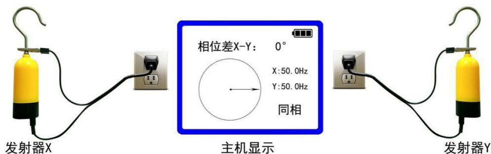
提示：自检时两发射器与接收主机的距离大于0.5米为宜。当距离小于0.2米时，可能只连接了1个发射器而主机显示2个发射器信息。此现象为正常现象，不影响仪器使用。当2个发射器都接电时，仪器显示不受短距离影响。
