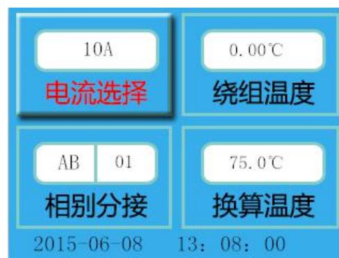
按循环键光标可在电流选择、相别分接、绕组温度、换算温度、数据查询、时钟修改、主机参数等包含的选项之间移动，按选择键可对上述七项主菜单包含的选项循环选择，当光标在绕组温度时，按启动键可使光标在三个数据位之间滚动显示，选择键可使每个数据位的数据在 0~9 之间循环显示，选定测试电流后，当前选项为除绕组温度之外的任何选项时按启动键可启动测量。
