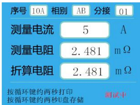
4、测试完毕后，按“复位”键，仪器电源断开，同时放电，音响报警，液晶恢复初始状态，放电音响结束后，请一定稍等 10 秒钟左右，重新接线进行下次测量，或拆下测试线与电源线结束测量。
