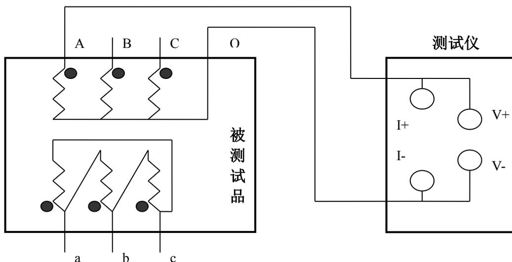
B、助磁法接线见图三~五（适用于  $Y_{(N)}$ -d-11 联接组别）。
