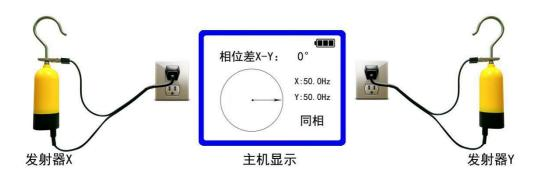
提示:自检时两发射器与接收主机的距离大于0.5米为宜。当距离小于0.2米时,可能只连接了1个发射器而主机显示2个发射器信息。此现象为正常现象,不影响仪器使用。当2个发射器都接电时,仪器显示不受短距离影响。
